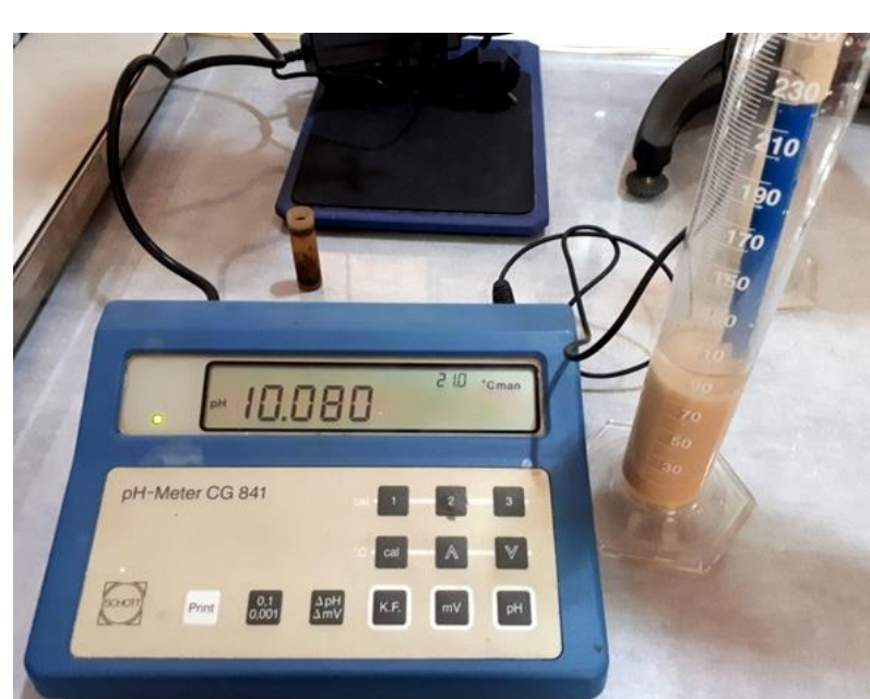
Figure 5. Résultat du test pH L'échantillon Ca-B, avec un pH de 10 conforme aux normes pharmaceutiques
