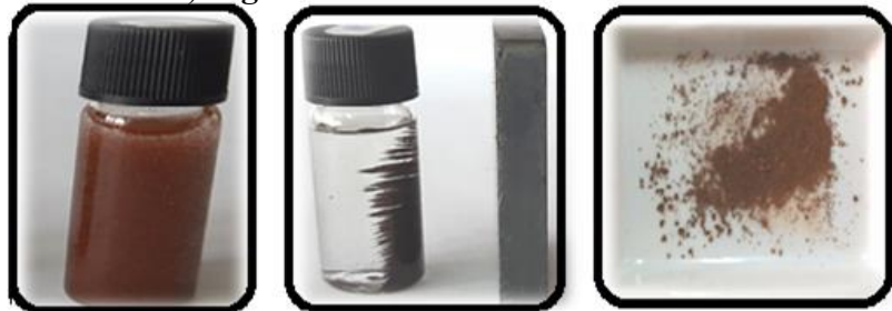
Figure 1. Suspension aqueuse de \text{Fe}_3\text{O}_4 avant et après application d'un champ magnétique externe et \text{Fe}_3\text{O}_4 sèches
